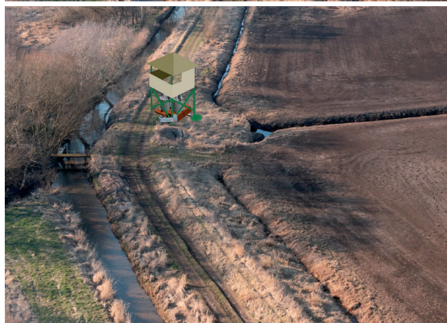
Figur 5: Kompakte fosforfiltre kunne placeres inde i et fugletårn eller lignende. Hvis der sættes sider på tårnet, vil filteret ikke være synligt i terræn. Illustration: SEGES Innovation
