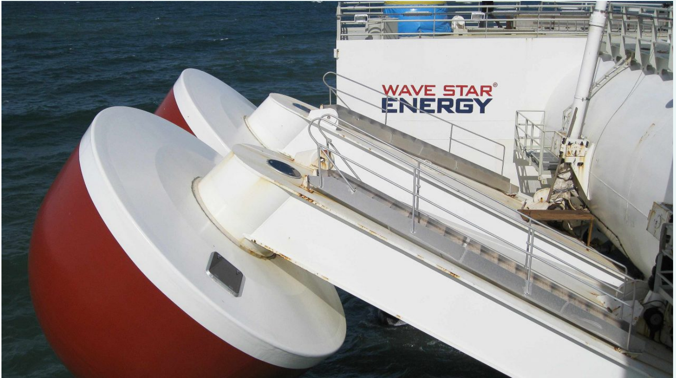
Der kom strøm ud af det, når de to store flydere på Wave Stars testanlæg ved Hanstholm bevægede sig op og ned i vandet. [Foto: S. N. Swiatecki]
