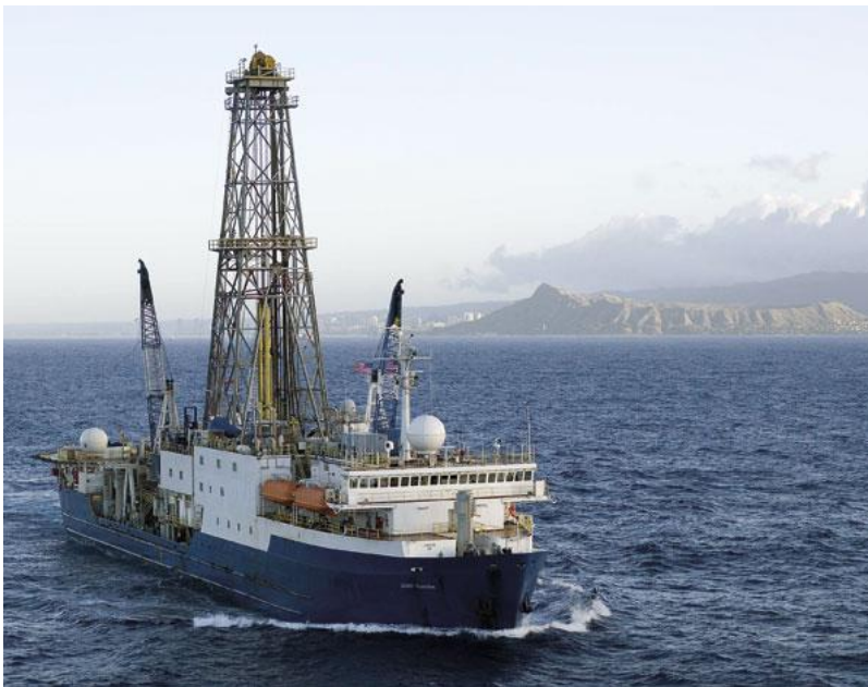
JOIDES Resolution er forskningsboreskibet for IODP [Integrated Ocean Drilling Program]. Det er 143 meter langt og kan bore 2000 meter ned i havbunden på havdybder ned til 7000 meter. [Foto: IODP-USIO]
