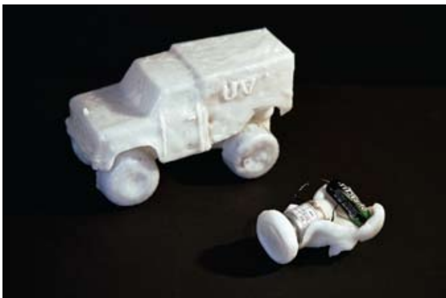
[3,9] Formplast kan til enhver tid opvarmes og omformes – brug varmt vand, en hårtørrer eller lign.
