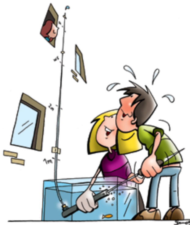
[2.6] Husk at placere pumpen, så den kan tage vand ind fra toppen. Tæl antal slag og mål højden
